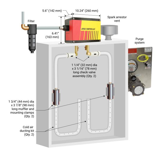
SHOWN TOP MOUNTED ON CUSTOMER'S ENCLOSURE PURGE SYSTEM SHOWN FOR REFERENCE ONLY
